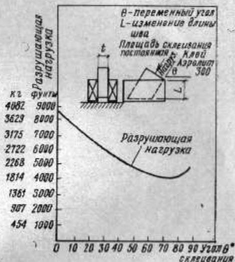
Рис. 35. Кривая разрушающей нагрузки при испытании образцов, склеенных под углом
