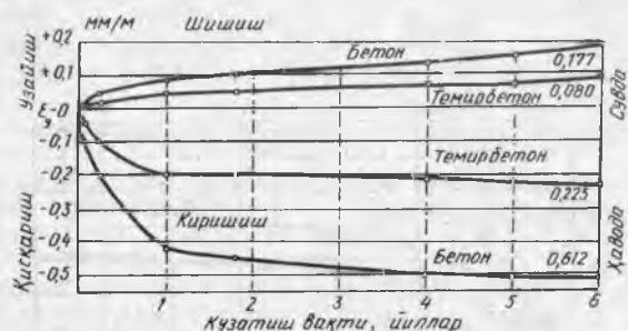
3.7-расм. Бетон ва темир-бетонда вақт мобайнида чуқиш деформацияси ва кўпчишининг ривожланиши.
