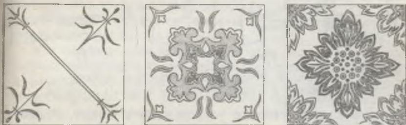
Рис. 17. Керамические плитки для внутренней облицовки стен, декорированные методом сериографии
