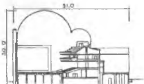
10. Madriddagi sportzal binosining qirgimi. Tom yopmasi temir-beton qobiq. Trubunalar – uch yarusli
