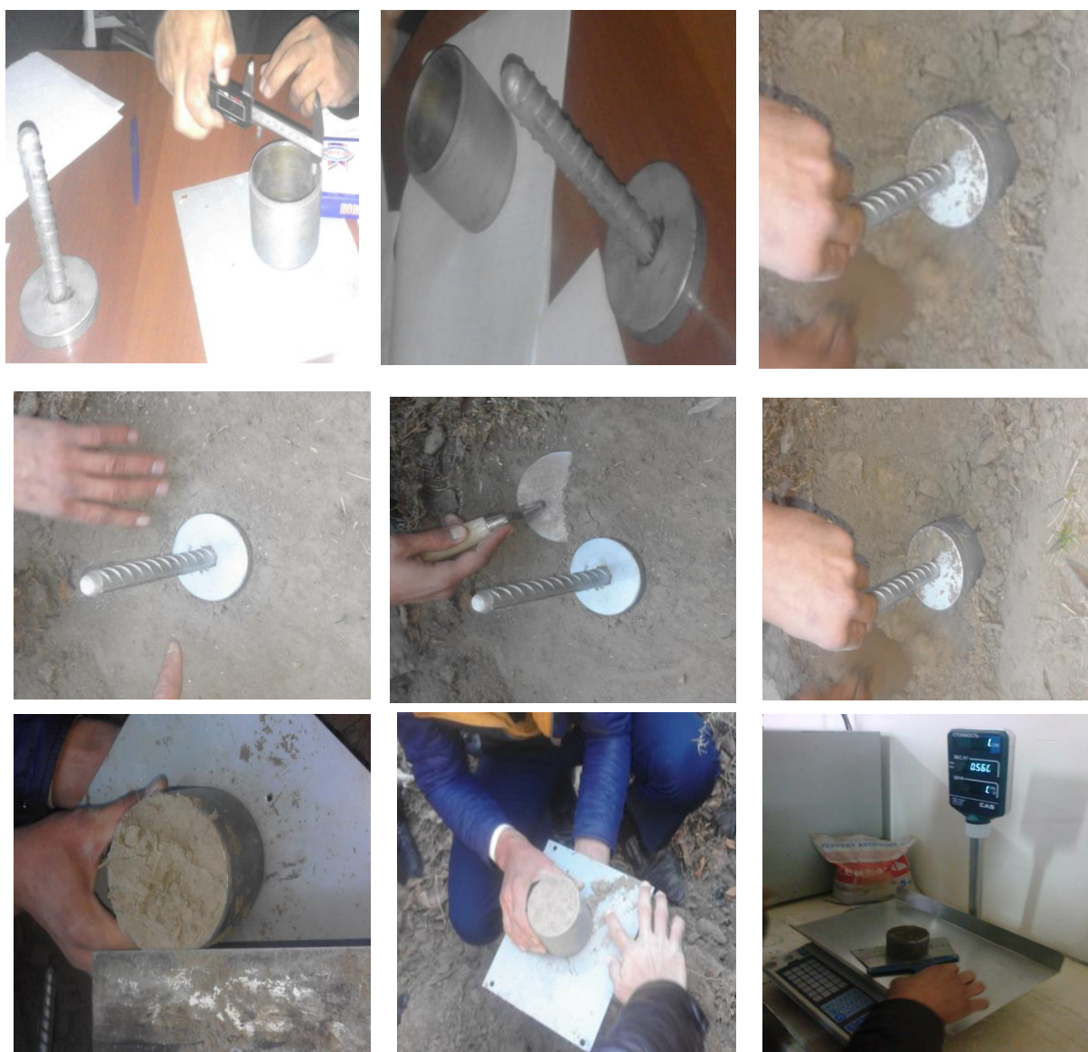
6.11-rasm. Kesuvchi halqa usulida gruntning tabiiy zichligini aniqlash jarayonidan lavhalar
