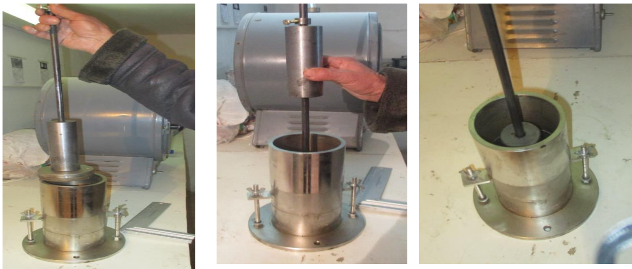
4.3-rasm. Turli namliklardagi gruntning zichlash qurilmasi
