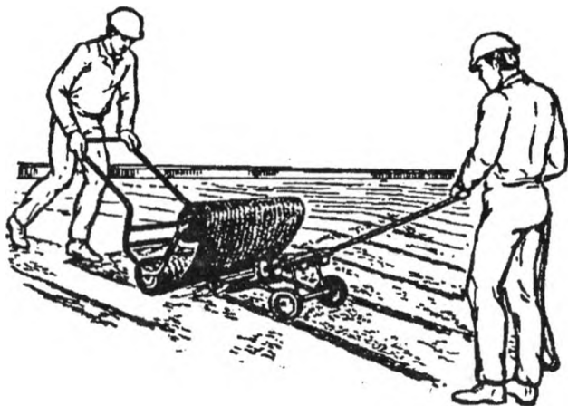
9.1- rasm. Eritiladigan ruberoid asosida tomni gidroizolatsiyalash
