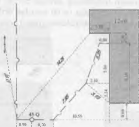
32-rasm. Gazo'tkazgich tarmoq trassasini kombinatsiya usulida planga olish sxemasi.
