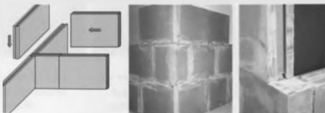
14.12-rasm. Kesishadigan pardevorlarni qurishda plitalar montajining sxemasi.
