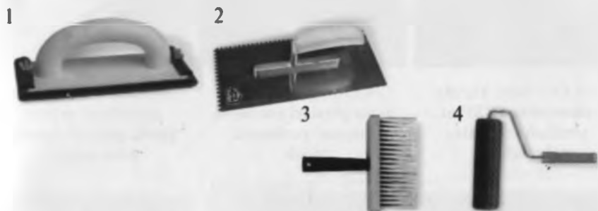
14.7-rasm. O'TP larning yuzalarini pardoqlash uchun asboblari:
