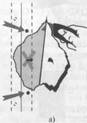
11.14-rasm. Yuza qatlamning shikastlangan joylarini ta'mirlash: a – birinchi jarayon; b – ikkinchi jarayon.
