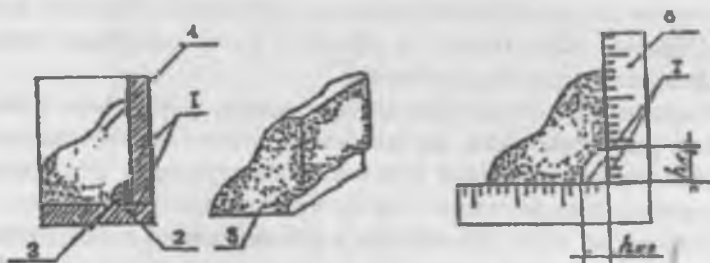
Рис. 6.20. Схема измерения сечения угловых швов с помощью снятия слепка:
