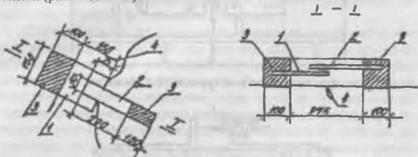
Рис. 6.15. Пластиновый маяк из двух окрашенных пластинок: 1 - пластинка, окрашенная в белый цвет; 2 - пластинка, окрашенная в красный цвет; 3 - гипсовые плитки; 4 - трещина.
