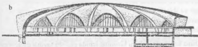
27.9-rasm. Bozor ustidagi to'liqli gumbaz: a—umumiy ko'rinishi; b—qirqimi
