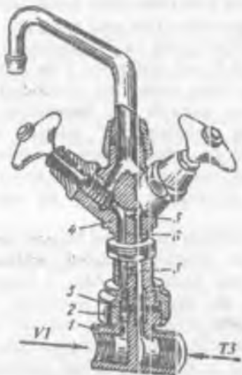
3.11-rasm. Markaziy aralashtirgichli yuvgichning nosozligi:
