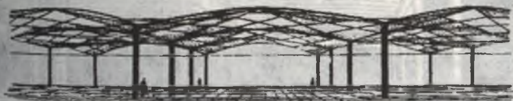
1.19-расм. Интерьернинг фазовий куринишига бинолар ёпма кўтарувчи элементлари турларининг таъсири а-рама тусияли ёпма; б-арра шаклидаги чорчўп; в-кобиқли; г-гиперболик параболойда шаклидаги қобиқларда
