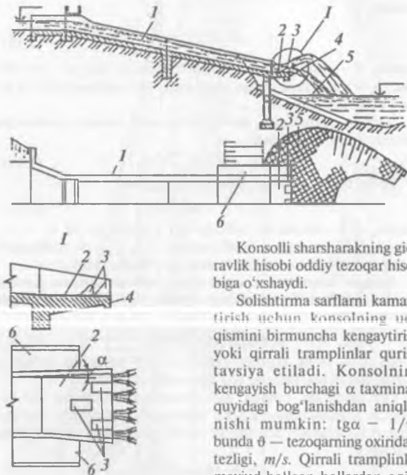
2.5- rasm. Konsolli sharsharak: 1—nov; 2—konsol; 3—trampolinlar; 4—suv oqizma; 5—qirg'oq qoplamasi; 6—xizmat ko'prigi. I — konsolli sharsharakning chiqish qismining ko'rinishi.
