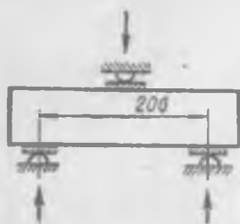
34-расм. Гиштни эгилишга синаш схемаси
