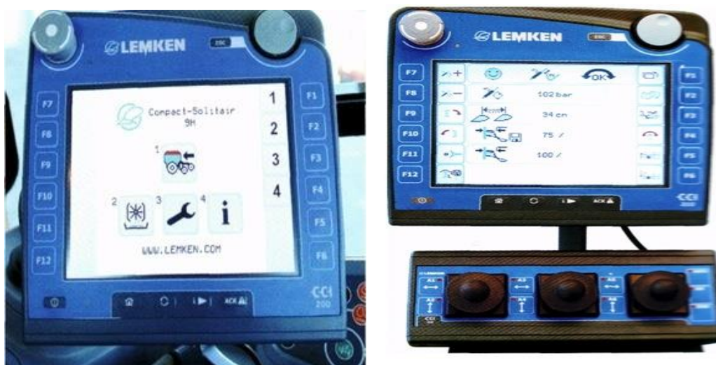
7.4-расм. Белгилар ва пиктограмма қурилмаси (а) ҳамда плугни бошқариш учун джойстли CCI/ISOBUS терминали (б)
