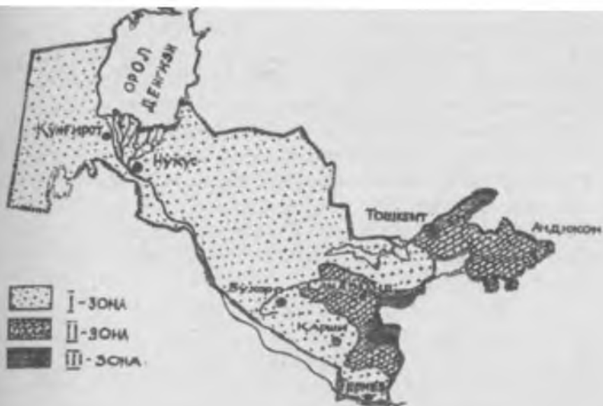
17-расм. Қишлоқ уйларини қуришда республика ҳудудининг шароитлари бир-биридан фарқ қилувчи қурилиш-иқлим зоналарга бўлиниши: I зона-чўл ва дашт иқлимининг фойдаланиш зоналари; II зона-қулай ландшафтли ва иқлим шароитли район; III зона-соғуқ қишчи баланд тоғли районлар.
