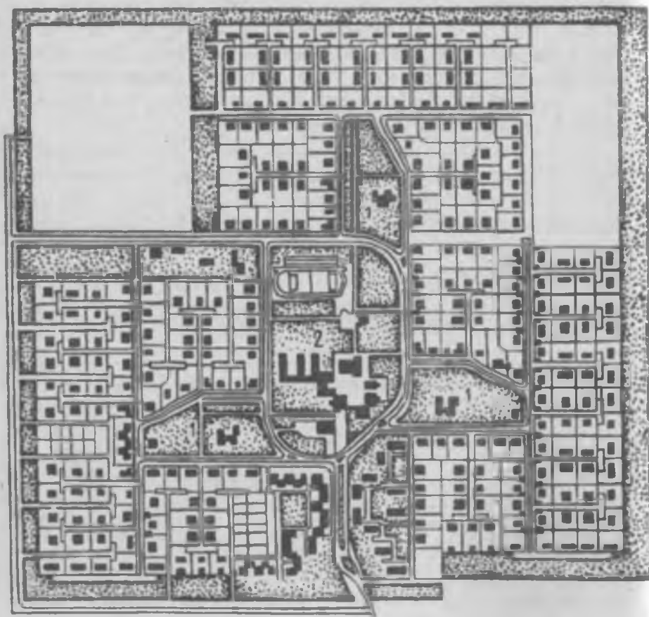
25-расм. Аҳоли сони жиҳатдан катта ва йирик қишлоқларда тураржой ҳудудининг умумий марказ атрофида жойлашган тураржой комплекслари услубида қурилиши. Қашқадаро вилоятидаги Қарши чўли 4 давлат ҳўжализининг бош режаси:
