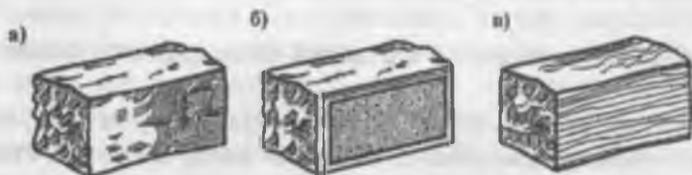
Рис. 2.3. Блоки: а - колотый; б - тесаный; в - пиленный.
