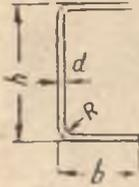
Обозначения:  $h$  — высота профиля;  $b$  — ширина полки;
