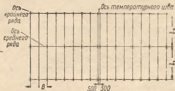
Рис. 3. План расположения колонн
