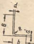
Обозначения:  $B$  — ширина большей полки;  $b$  — ширина меньшей полки;  $d$  — толщина полки;  $R$  — радиус внутреннего закругления, принимаемый для всех номеров профилей  $R=d$  и для угольников из низколегированных сталей  $R=1,5d$ .
