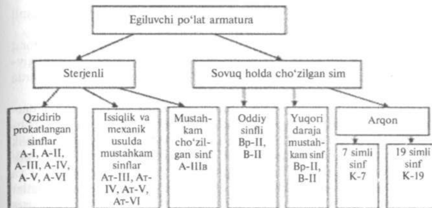
8.4- rasm. Temir-beton konstruksiyalar uchun po'lat armaturaning asosiy turlari.
