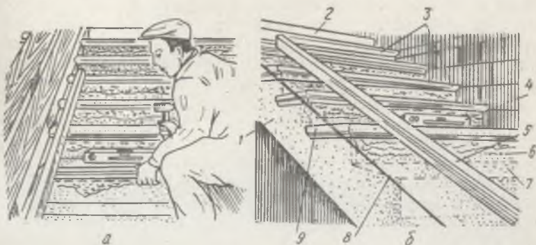
138- расм. Зина маршига мозаика зинапояларни ётқизиш (а) ва ётқизиш сифатини текшириш мосламалари (б):
