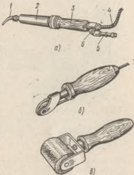
80-расм. Линолеумни қайноқ ҳаво билан пайвандлаш қуроллари:
