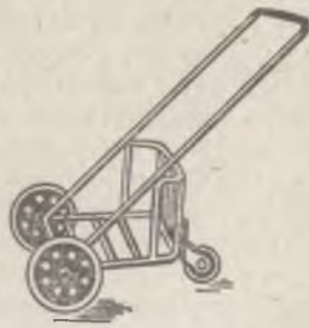
90-расм. Донали материалларни ташиш учун мўлжалланган икки (а) ва уч гилдиракли (б) аравачалар
