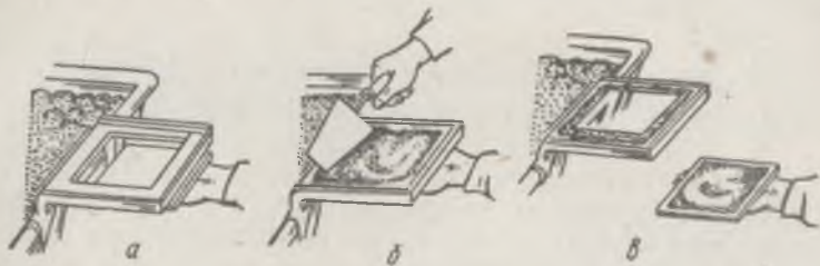
99- расм. Плиткани орқа томонига қоришма суркаш учун андаза-рамка:
