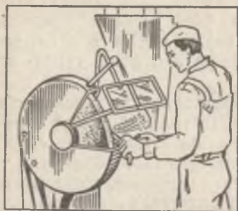
152-расм. Ҳимоя кожухли, экранли (а) ва ҳимоя экрансиз (б) чархлаш станогида ишлаш
