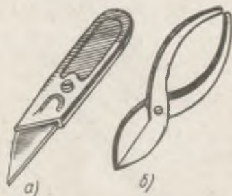
67- расм. Плиткалар қирқиш ва уларда думалоқ тешиклар очиш учун пичоқ (а) ҳамда дастаки қайчи (б)
