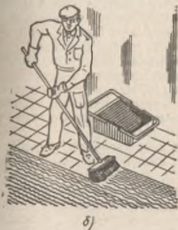
55- расм. Асосни чўтка ёрдамида қўлда грунтлаш:
