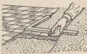
39-расм. Гўния ёрдамида кундаланг плиткalarни ётқизиш
