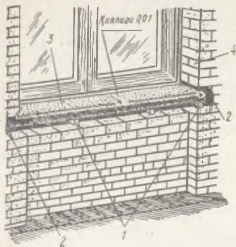
137- расм. Дераза токчаси плитасини ўрнатиш:
