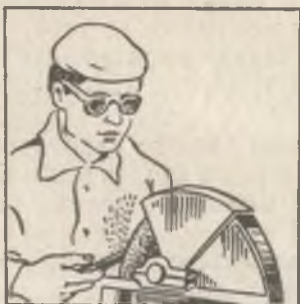
152-расм. Ҳимоя кожухли, экранли (а) ва ҳимоя экрансиз (б) чархлаш станогидида ишлаш
