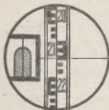
32-расм. Нивелир НВ-1 кузатиш труба сининг майдони.
