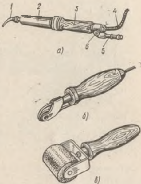
80-расм. Линолеумни қайноқ ҳаво билан пайвандлаш қуролари:
