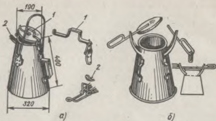
26- расм. Қизиган битумни иш ўрнига олиб бориш учун мўлжалланган оддий (а) ва Мосотделстрой трестининг (б) бачоклари:
