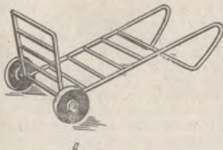
90-расм. Донали материалларни ташиш учун мўлжалланган икки (а) ва уч гилдиракли (б) аравачалар
