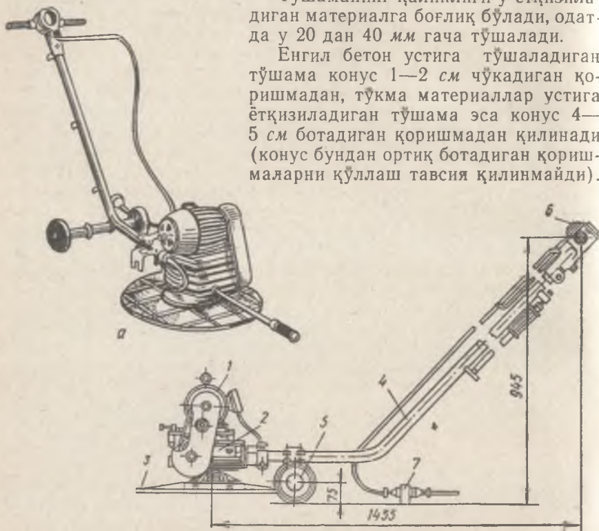
141- расм. Поллар учун асос бўладиган бетон сиртлар ва цемент тушамаларни текислаш ва силлиқлаш учун мўлжалланган СО-64 машинаси:
