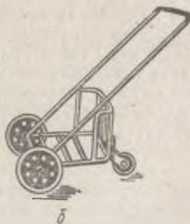
90-расм. Донали материалларни ташиш учун мўлжалланган икки (а) ва уч гилдиракли (б) аравачалар
