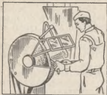
152-расм. Ҳимоя кожухли, экранли (а) ва ҳимоя экрансиз (б) чархлаш станогидида ишлаш
