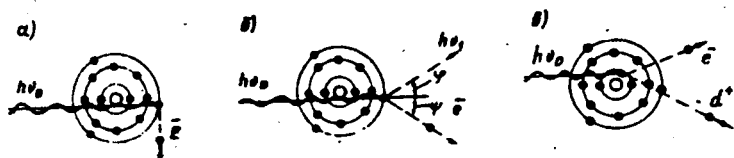
5-расм. Ионловчи нурланишнинг назорат қилинувчи объект материали билан ўзаро таъсир схемаси.
