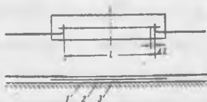
33 — расм. Қаршилиқ тензометрини ишлаш схемаси.
