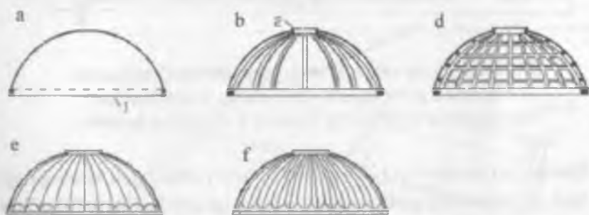
27.1- rasm . Gumbaz konstruksiyalarining ko'rinishlari:
