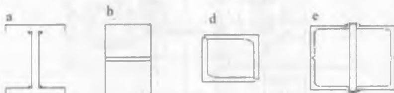
24.4-rasm. Po'lat karkaslar ustunlari: a, b—tasmali po'latdan; d, e—burchakliklardan
