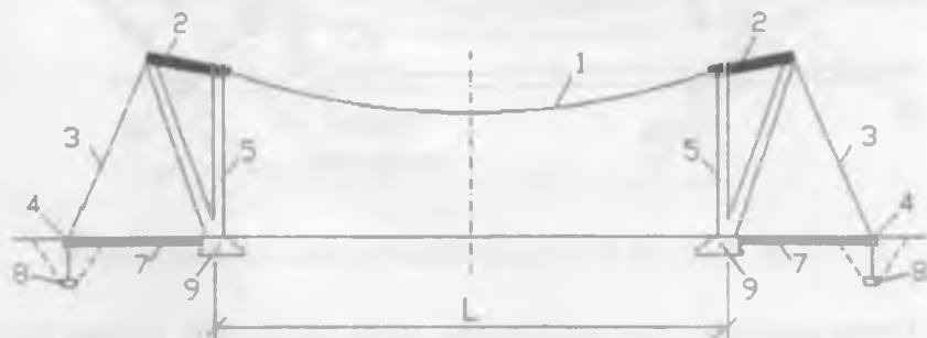
28.2-rasm. Tortmali osma tom sxemasi:
