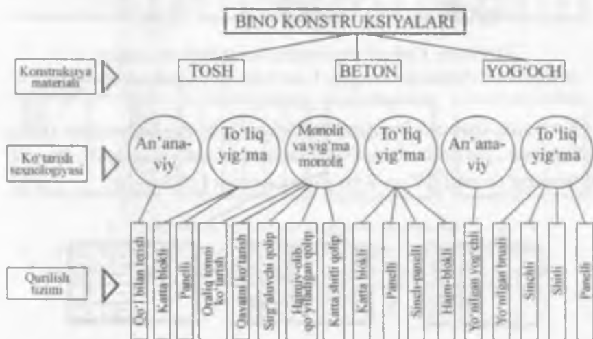
11.1-rasm. Binolarning qurilish tizimlari
