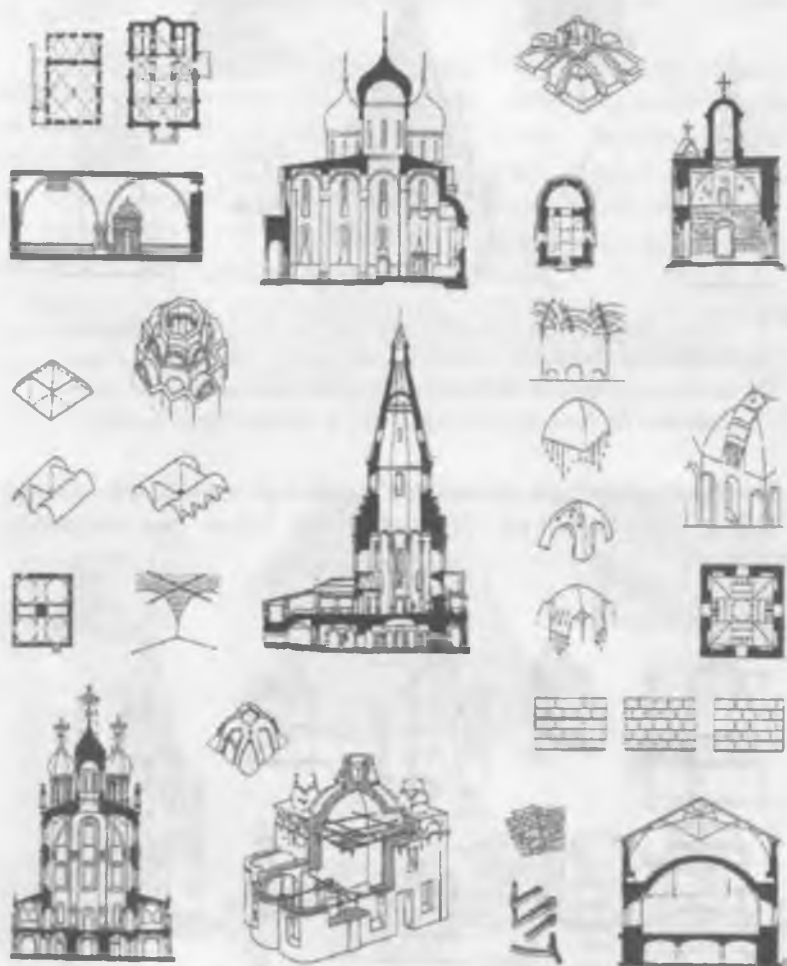
5.16 - rasm. XV–XVII asrlarda Moskva davlati arxitekturasida struktura tiplari va tosh binolar konstruksiyalari
