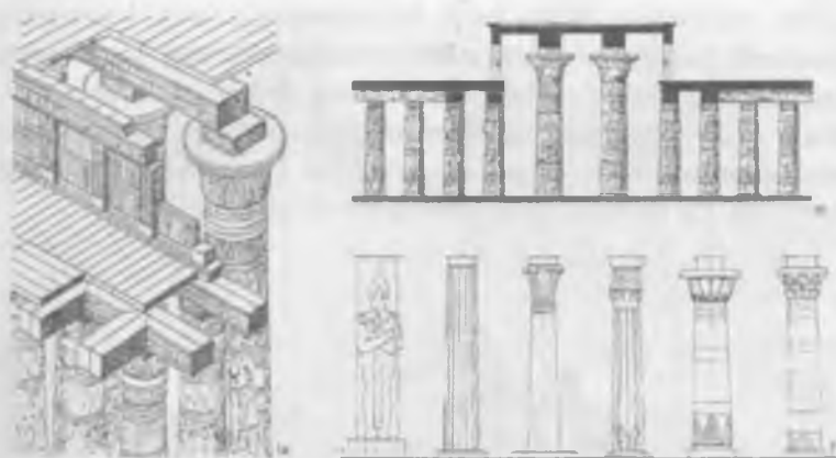
3.1 - rasm. Qadimgi Misrda ustun - to'sin konstruktiv tizimi.
