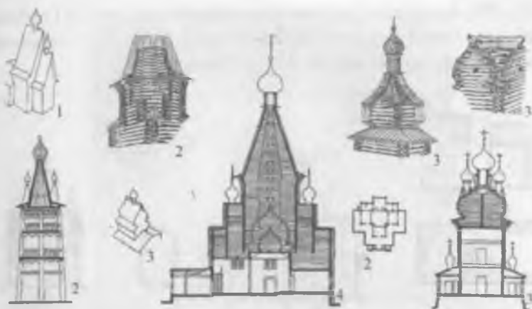
5.14-rasm. Qadimgi rus arxitekturasida yog'ochdan tayyorlangan diniy inshootlarning konstruktiv shakllari. 1-ikki qiyali oddiy cherkov binosi; 2-cherkov va qo'ng'iroq inshootlari; 3-yopma konstruksiyasi bochka va kubsimon bo'lgan cherkov inshootlari; 4-cherkov binosi qirqimi
