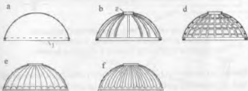
27.1- rasm . Gumbaz konstruksiyalarining ko'rinishlari:
