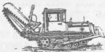
58-расм. Занжирли-шнелли конвейерга эга бўлган хандақ экскаваторлари; а - чўмичсиз; б - «Беларусь» тракторига осилган қирғич; в - гусеничали тракторга осилган қирғичли;
