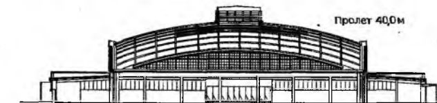
Покрытие - сборный железобетонный купол-оболочка
