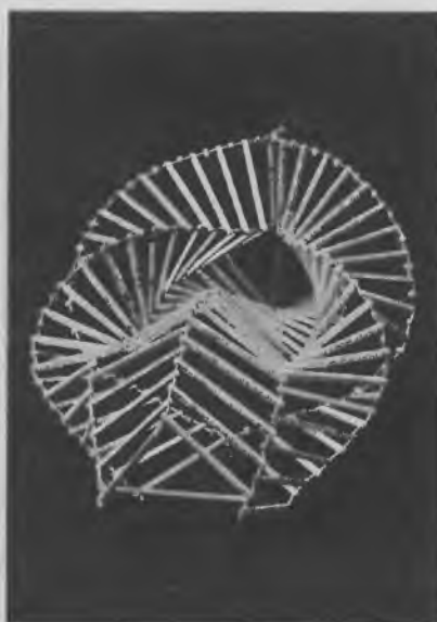
Рис. 108. Варианты конструкции на основе семисекционной структуры. Конструктивная идея — архит. Ю.С. Лебедев, лаборанты В.И. Тимофеевичев и В.Ф. Смирнов
