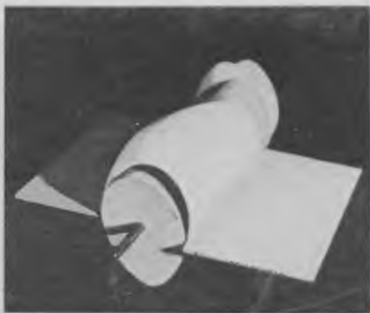
Рис. В. Технологическая модель получения оболочек-скорлуп для покрытий зданий
