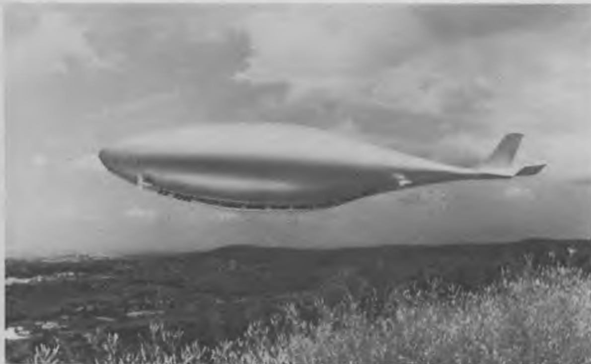
Рис. 18. "Айрфиш" ("летающая рыба"). Пневматическая модель. (ИЛ, Ф. Отто, Р. Бартель, Х. Достер и И. Фритц); инженерное бюро: Хаппельд-Бат (Англия) при участии Ж. Лидделя; специалисты по аэронавтике: Гренфильский технологический институт (Англия)
