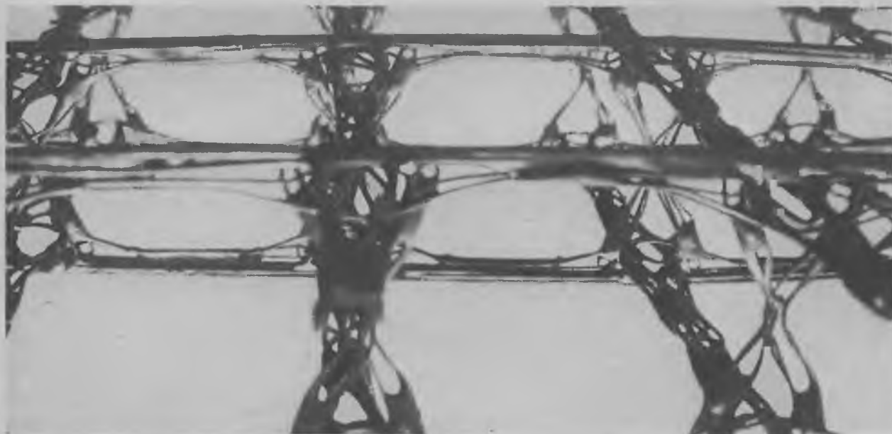
Рис. 12. Изгибающиеся плиты в виде интегрированных в плоскости балок. Исследование фахверковых систем (ИЛ, Ф. Отто, Штутгарт-Вармброн, 1965)
