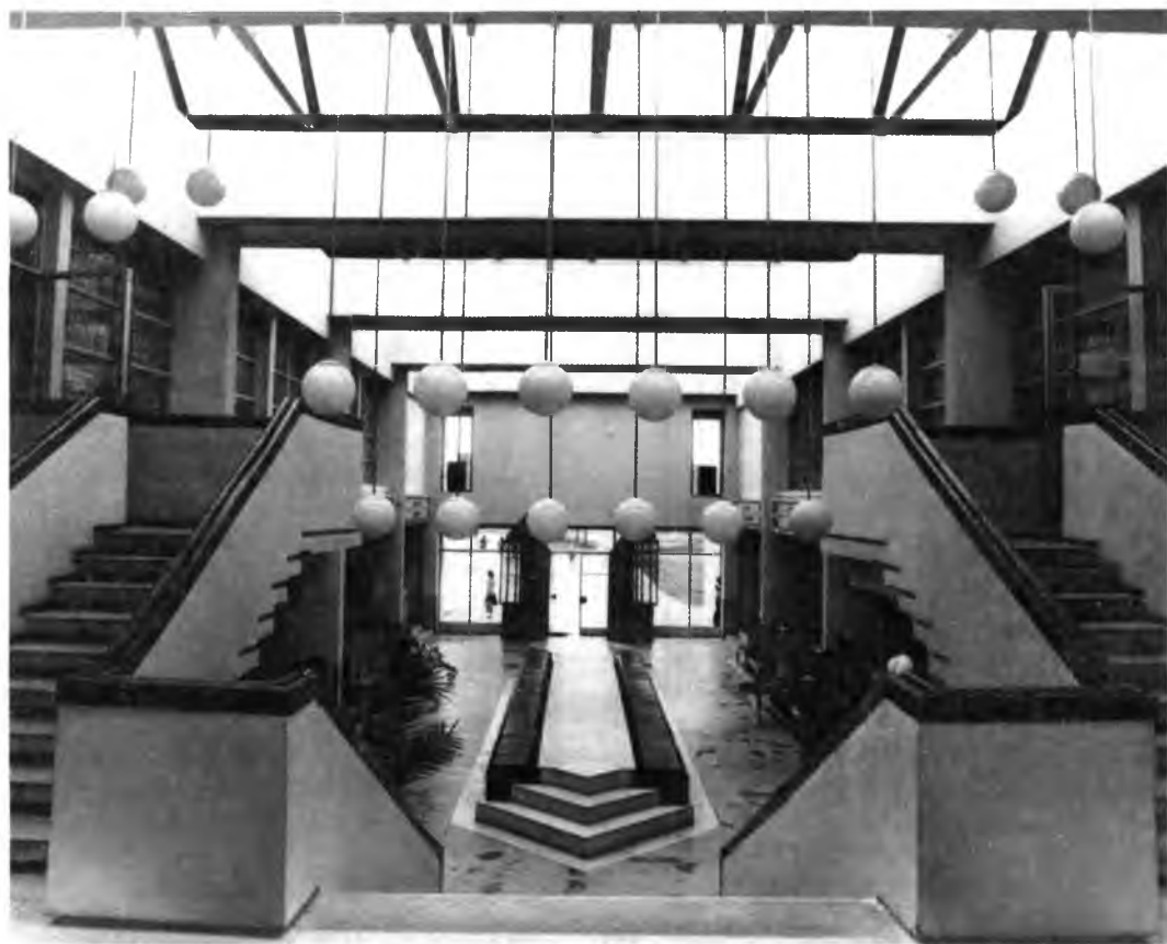
Планировочное решение входных узлов. Тамбуры при прямолинейном движении; один из вестибюлей с размещением гардеробов
