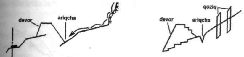
46-rasm. Qiya sathlarda toshlarni ushlab qoluvchi devorlar, qoziqlar va ariqchalar qurish.
