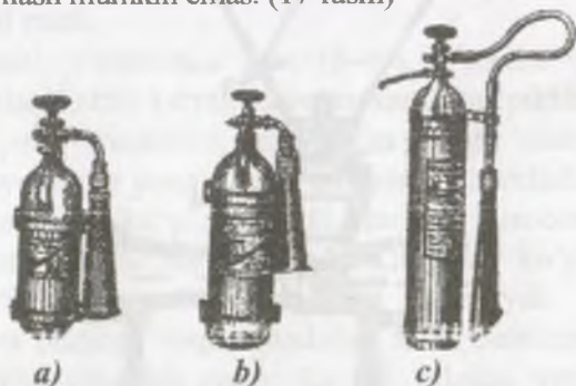
17-rasm. Karbon kislotali o't o'chirgichlar a) OU-2, b) OU-5, c) OU-8
