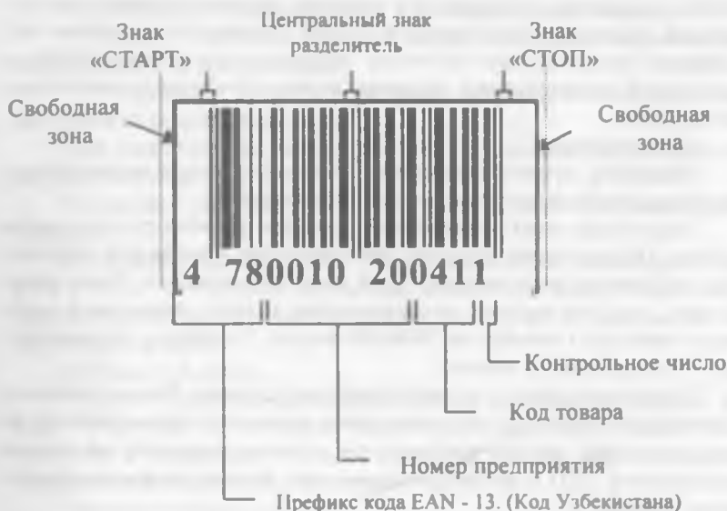
Рисунок 9а. Структура кода EAN - 13
