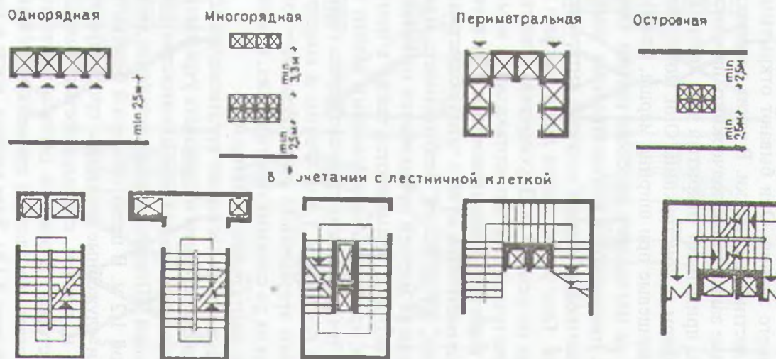
Рис. 9.1.9. Схемы вариантов организации лифтового хозяйства в общественных зданиях
