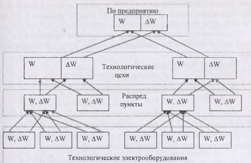
Рис. 2.2. Структурная схема формирования расчетных данных энергобаланса объекта энергосистемы.
