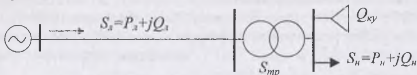
Рис. 4.7. Радиальная схема внутриводского электроснабжения.
