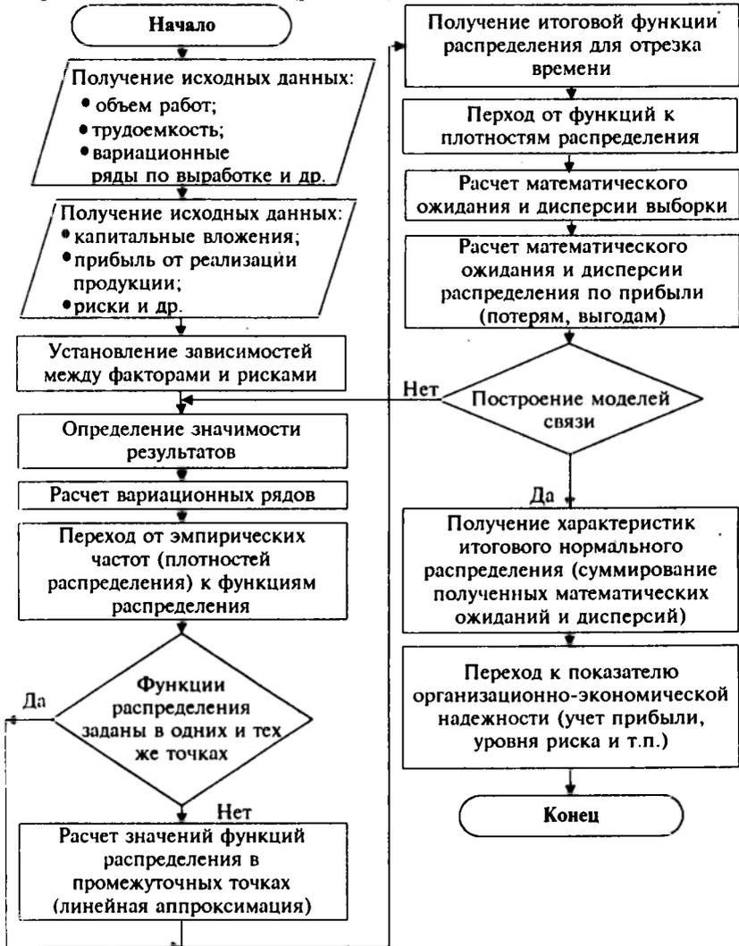
Рис. 7.7. Схема получения показателя надежности и уровня риска
