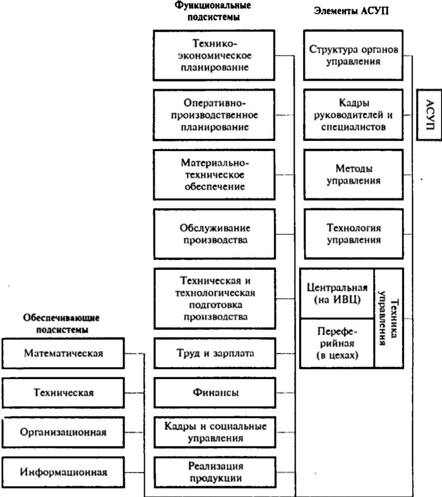
Рис. 3.13. Состав АСУП и виды ее обеспечения
