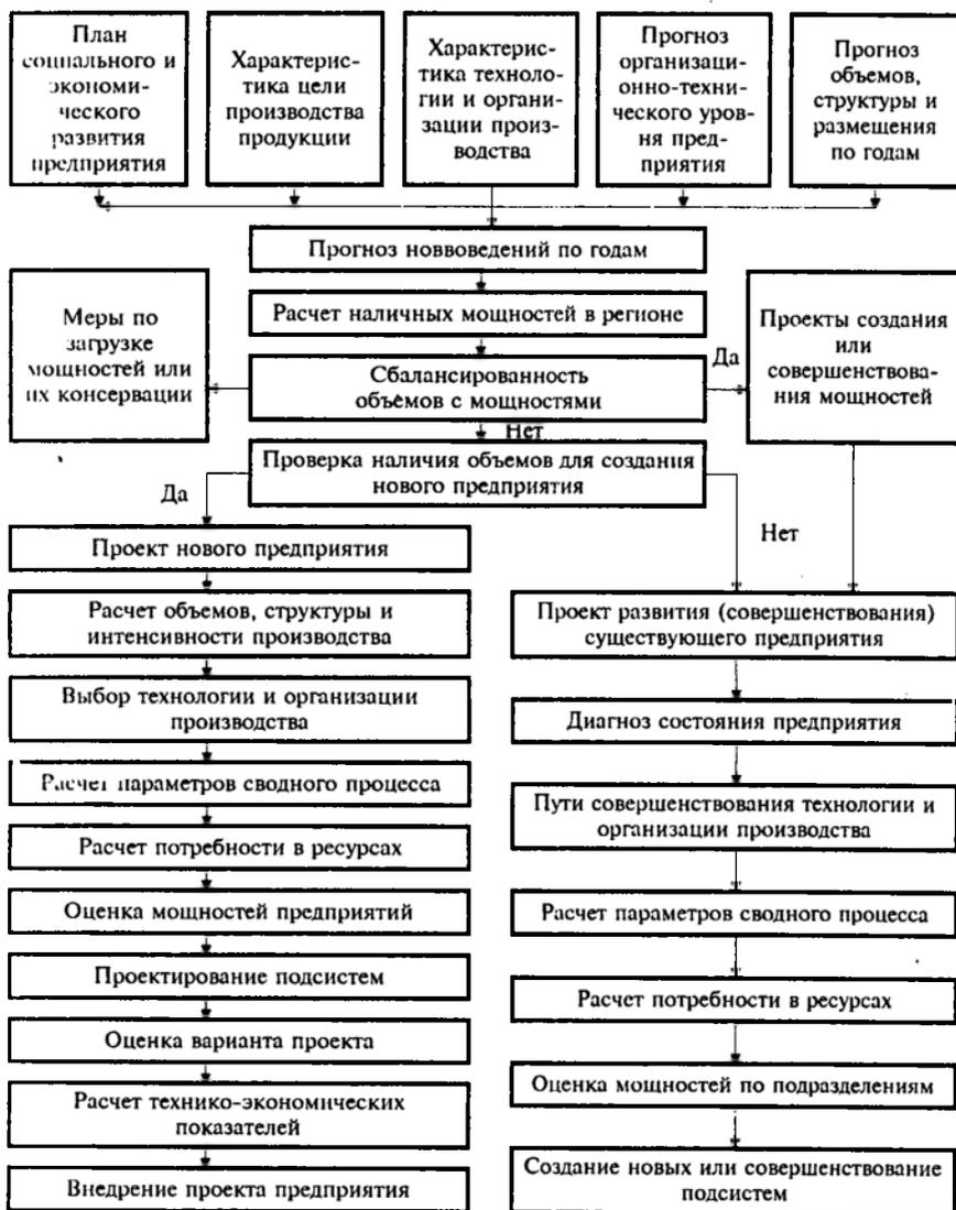
Рис. 5.23\*. Принципиальная схема проектирования производственной системы с достаточным потенциалом
