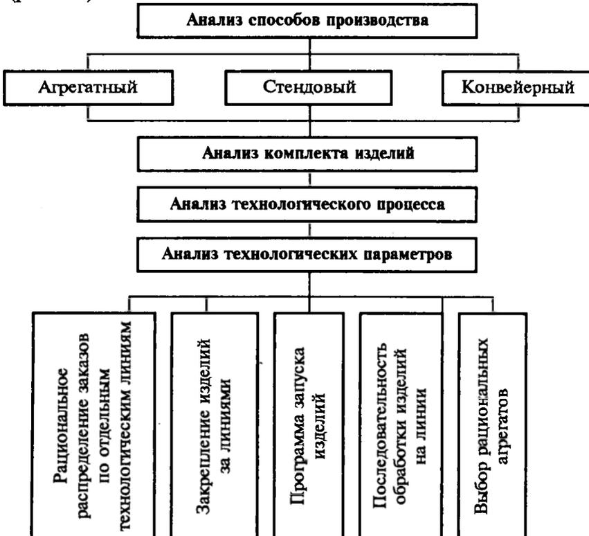
Рис. 2.8. Технический анализ производства комплекта изделий на технологических линиях
