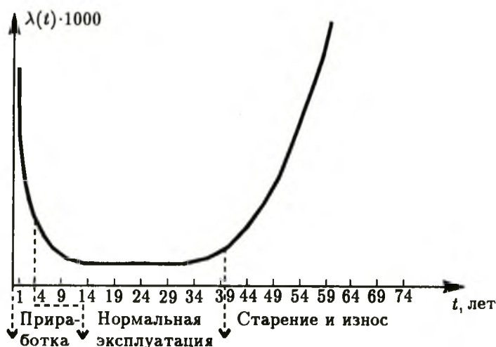
Рис. 3.6. Типичное поведение кривой смертности (интенсивности отказов): кривая описывает изменение коэффициента смертности мужского населения Франции по данным 1955 г. 1
