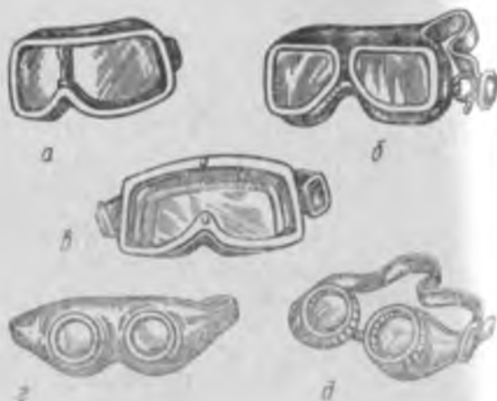
Рис. 19. Очки защитные: а—в—с прямой вентиляцией типа ЗП2-84, ЗП3-84 и ЗП1-90; г—с непрямой вентиляцией ЗП3-68-В-1; д—с непрямой вентиляцией и регулирующей перемычкой со светофильтрами.
