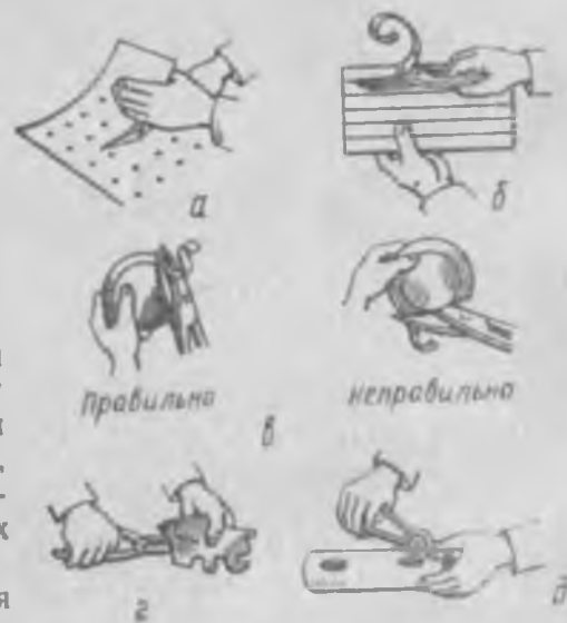
Рис. 25. Безопасные приемы работы с ножницами: а — разрезание листа на широкие полосы; б — разрезание листа на узкие полосы; в — вырезание заготовок круглой формы; г — вырезание детали с криволинейными очертаниями; д — вырезание отверстий в детали.
