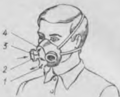
20 Типы фильтрующих СИЗОД: а — фильтрующая полумаска; б — патронный респиратор: 1 — полумаска; 2 — клапан вдоха; 3 — фильтрующий патрон; 4 — клапан выдоха.
