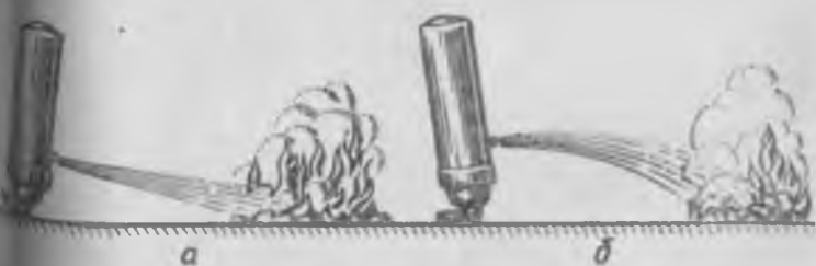
43 Направление струи пены из огнетушителя: а — неправильно; б — правильно.
