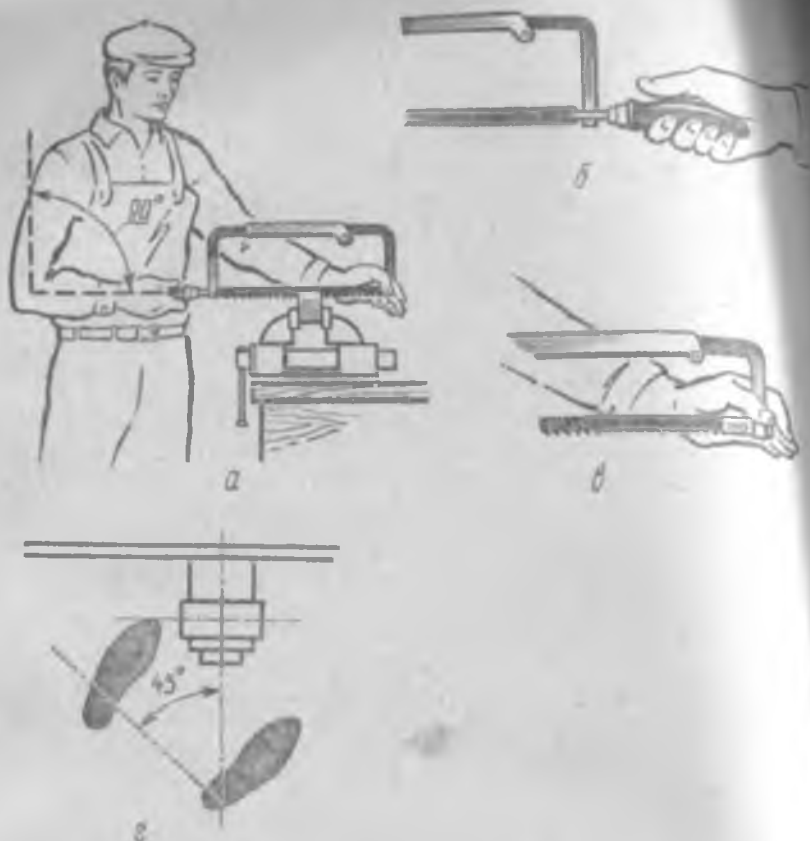
Рис. 26 Разрезание металлов ножовкой: а — положение корпуса; б — положение правой руки; в — положение левой руки; г — положение ног
