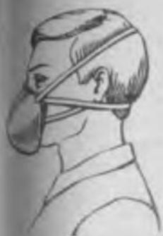
20 Типы фильтрующих СИЗОД: а — фильтрующая полумаска; б — патронный респиратор: 1 — полумаска; 2 — клапан вдоха; 3 — фильтрующий патрон; 4 — клапан выдоха.
