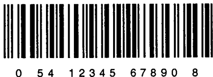
Рис. 63. Код ITF-14. Применяется для кодирования отгрузочных упаковок
