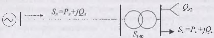
Рис. 4.7. Радиальная схема внутриводского электроснабжения.
