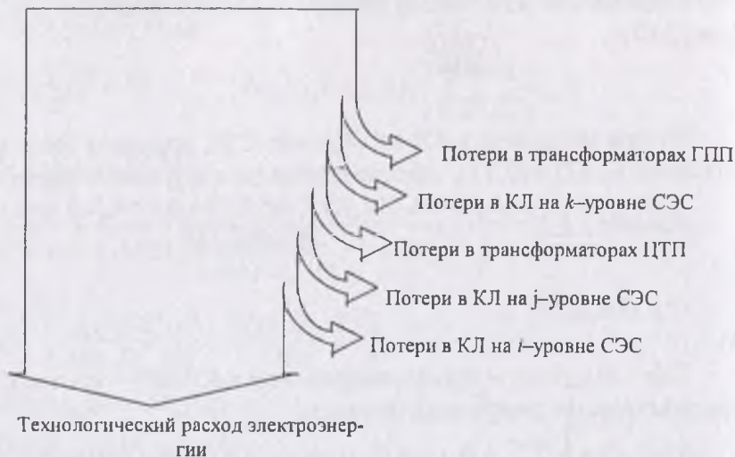
Рис. 2.8. Структура энергобаланса предприятия по ступеням СЭС.
