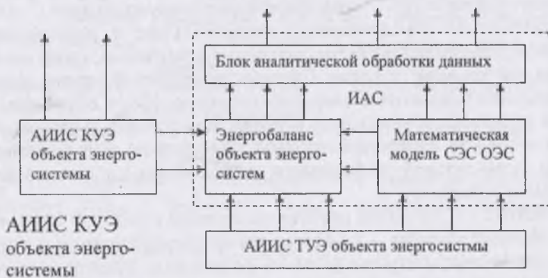
Рис. 5.13. Структурная схема совместного функционирования АИИС КУЭ и АИИС ТУЭ с использованием ИАС по энергоэффективности
