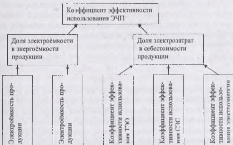
Рис. 5.4. Структура обобщенного коэффициента эффективности использования электрической энергии на производстве.
