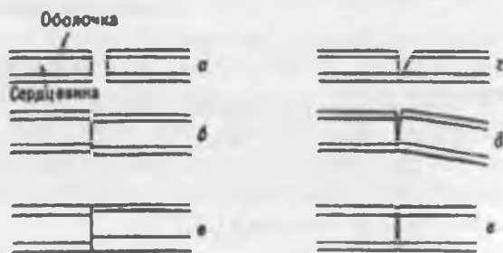
1.24-rasm. Tolali yorug'lik o'tkazgichlarni ulashdagi defektlarning ba'zi turlari: a – chekka qismlar bir-biriga tegmaydi, b – tolalar nokoaksial, c – o'zaklar nokonsentrik, d – kesim yuzalari tolalarning o'qlariga noperpendikulyar, e – tolalarning o'qlari burchak ostida bir-biriga yo'nalgan, e – tolalarning oxirlari ifloslangan.
