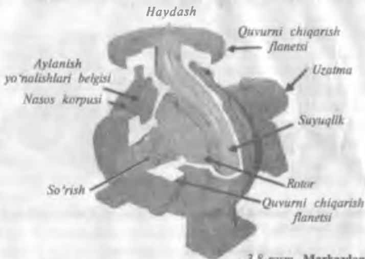
3.8-rasm. Markazdan qochma nasosning kesimda ko'rinishi.
