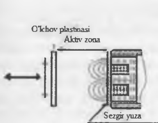
2.11-rasm. Datchikning aktiv zonasi
