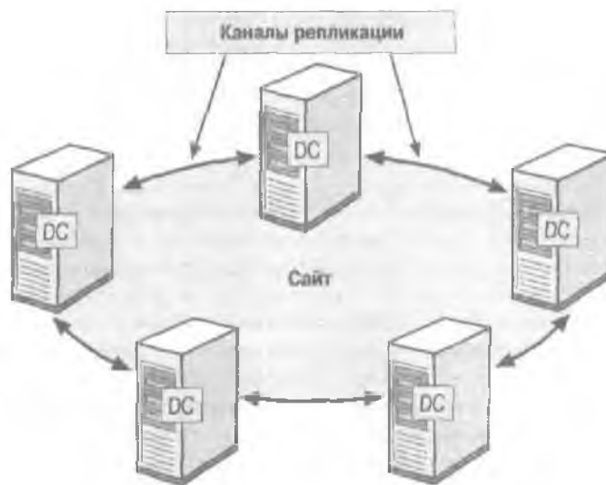
Рис. 9-3. Топология репликации между контроллерами домена (DC)
