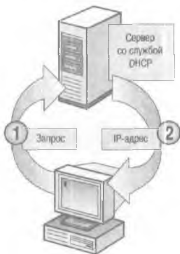
Рис. 7-3. Назначение IP-адресов DHCP-сервером
