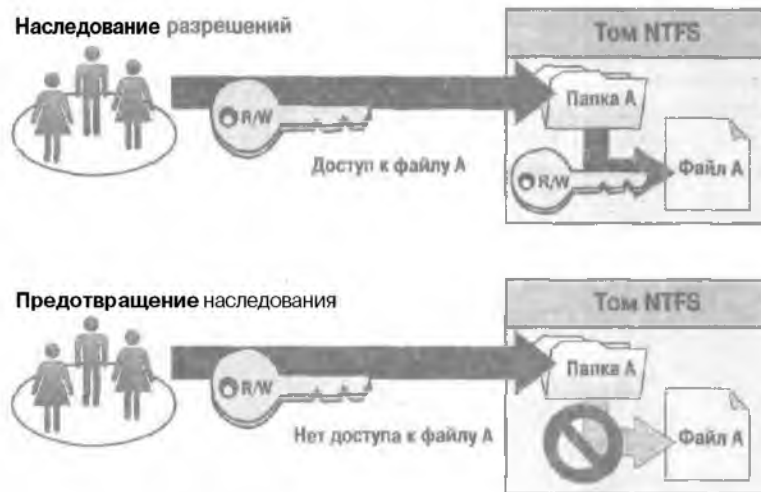
Рис. 14-2. Наследование разрешений и его отмена
