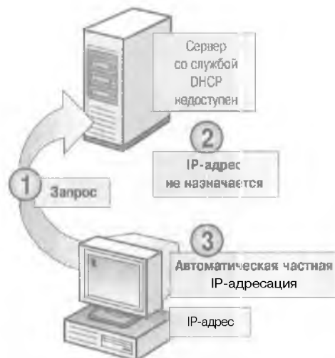
Рис. 7-4. Автоматическая частная IP-адресация
