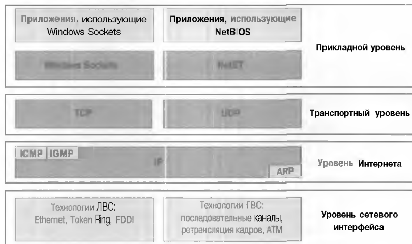
Рис. 7-1. Четыре уровня пакета протоколов TCP/IP
