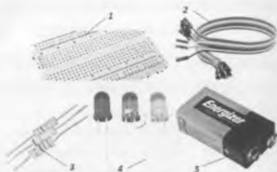
1-Maket (Breadboard); 2-Maketda ulash uchun o'tkazgich simlari (Wire Link); 3-1 kOm qarshilikli rezistor; 4-5 mmli LED; 5-9V'li batareya yoki boshqa elektr energiya manbai.
