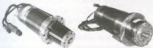
4.1.10-rasm. Raqamli dasturli boshqariladigan stanoklar uchun asbobni avtomatik almashtirish xususiyatiga ega elektroshpindellar
