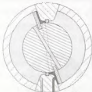
3.2.11-rasm. Ikki plastinali aylanuvchi gidrodvigatel
