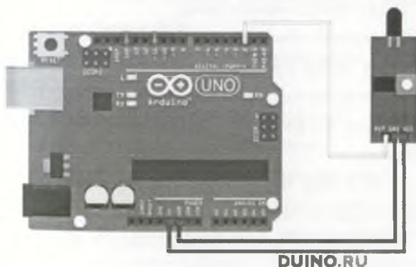
3.7-rasm. Datchikning kontrollerga ulash sxemasi
