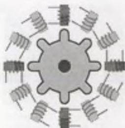
3.1.10-rasm. O'zgaruvchan magnitli qarshilikli qadamli dvigatel o'ramlarini ulash sxemasi
