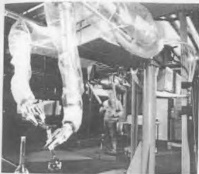
2.2.4-rasm. "Telerobot" (Italiya) firmasining Maskot harakatni takrorlovchi manipulyatori
