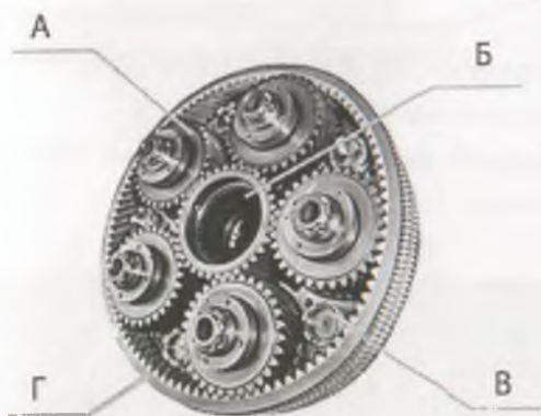
А) satelitlar; Б) quyosh g'altagi; В) vodilo; Г) markaziy tojli g'alak
