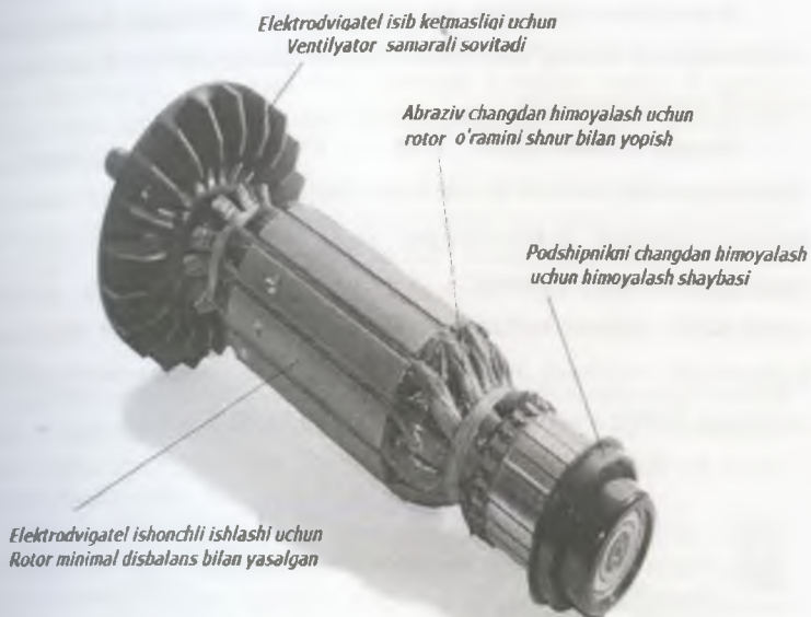
3.1.6-rasm. Ko'p o'ramli rotor
