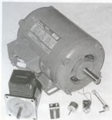
3.1.4-rasm. Har xil quvvatli elektrdvigatellar
