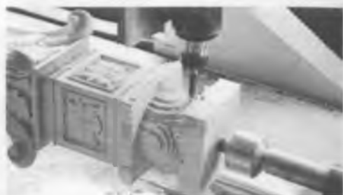
2.1.9-rasm. Raqamli dasturli boshqariladigan stanoklar
