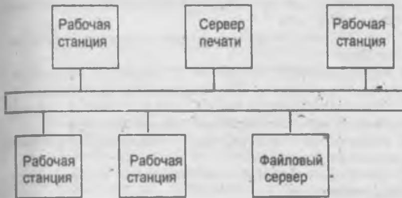
рис. 4.2 Шинная топология
