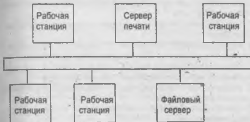
рис. 4.2 Шинная топология кабельных систем.
