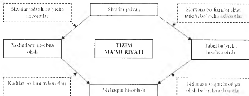
20.7-rasm. Kadrni boshqarishni ta'minlash uchun kompleks axborot tizimi modullarining funksional chizmasi
