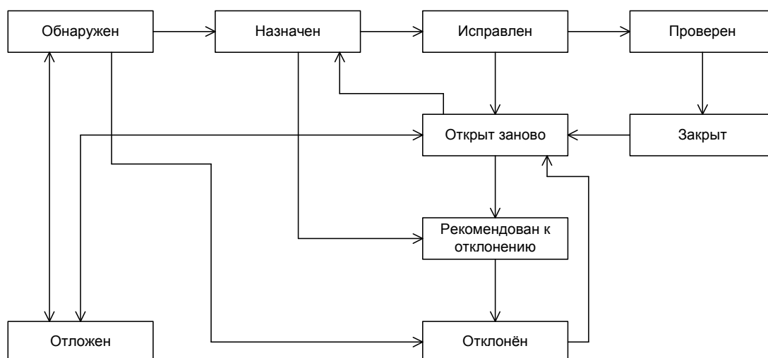
Рисунок 2.5.с — Жизненный цикл отчёта о дефекте с наиболее типичными переходами между состояниями
